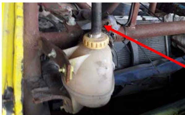
Bild 1 Schlauch als Überlauf am Ausgleichsbehälter -Der Schlauch muss in den Radkasten geführt werden.
